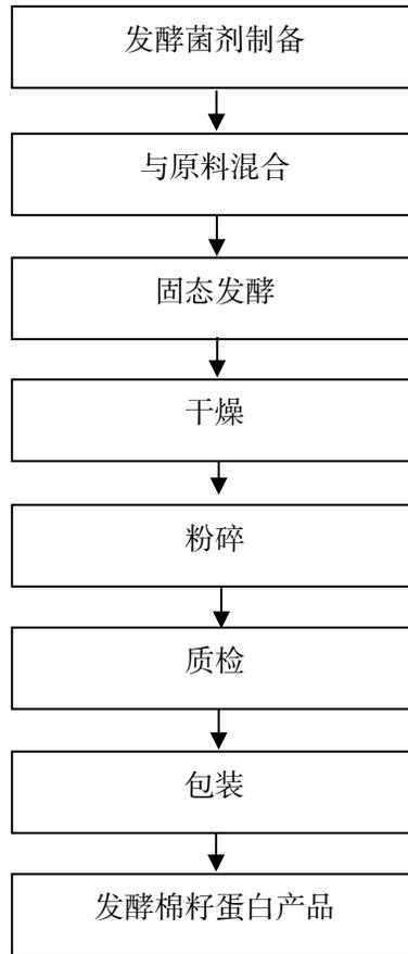
图 1 发酵棉籽蛋白工艺流程图
