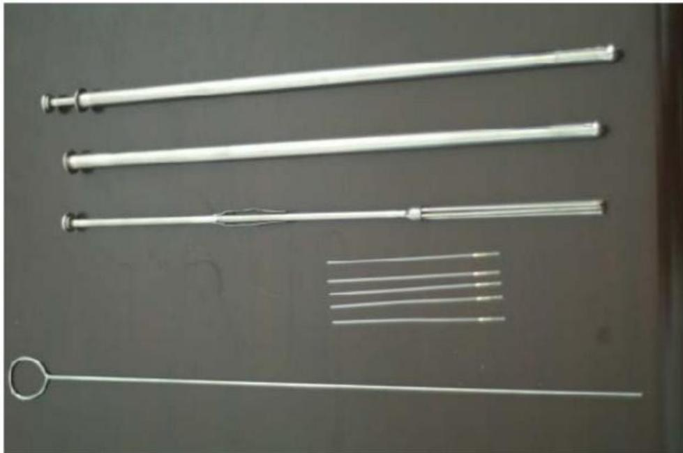
图 D.1 驴用输精枪主要部件平面图
